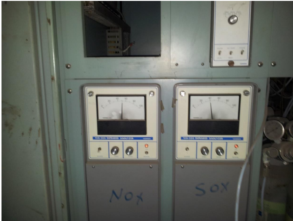
شكل 3. جهاز قياس أكسيد الكبريت وأكسيد النيتروجين.
