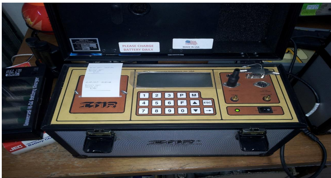
شكل 4. جهاز لقياس انبعاثات الغازات محمول الملوثة IMR - 7500
