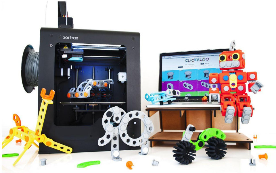
الشكل 4: تصميم وطباعة أجزاء ميكانيكية باستخدام الطباعة ثلاثية الأبعاد.
