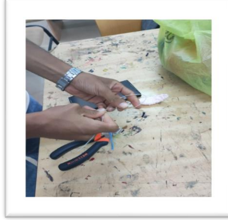
الشكل (1): يوضح تحضير الأسلاك المعدنية لتكون بمثابة خيوط السدة للنسج عليها.
