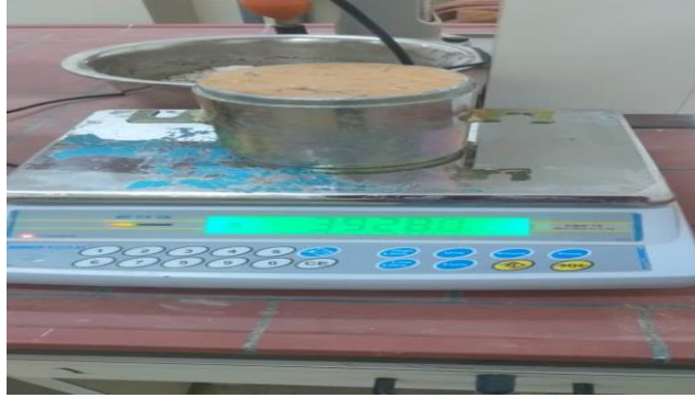
شكل 3 يوضح وزن القالب مع العينة المدموكة
