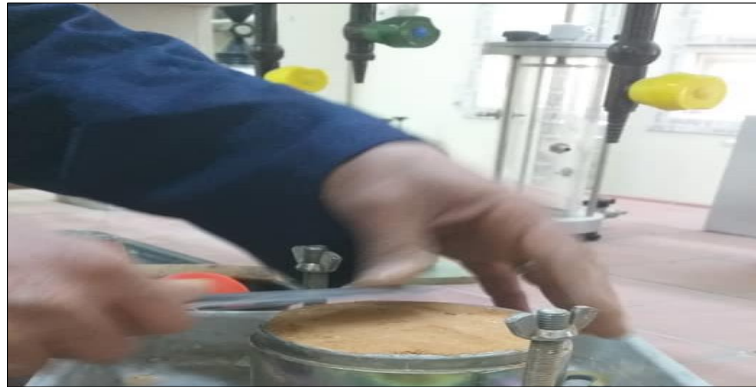
شكل 2 يوضح تسوية سطح العينة بعد الدمك
