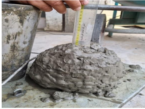
شكل (4): اختبار الهبوط (Slump Test)
