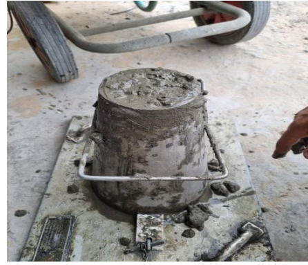
شكل (4): اختبار الهبوط (Slump Test)
