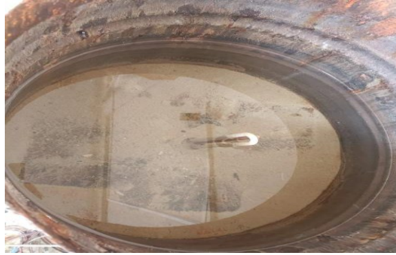
شكل (4): الحوض المستخدم في عملية المعالجة مزود بنظام التحكم بدرجة حرارة الماء
