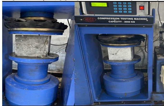
شكل (5): إحدى العينات داخل جهاز اختبار الضغط أثناء إجراء الاختبار
