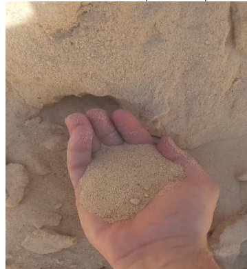
شكل (3): الفحص البصري للرمل المستخدم في الخلطات
