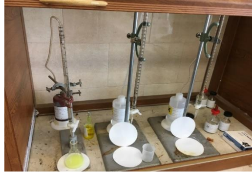
الشكل رقم (10): يوضح السحاحات المستخدمة في قياس الكلوريد، القلوية، الكربونات، البكربونات، العسر الكلي والأمونيا.
