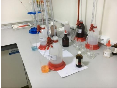
الشكل رقم (10): يوضح السحاحات المستخدمة في قياس الكلوريد، القلوية، الكربونات، البكربونات، العسر الكلي والأمونيا.
