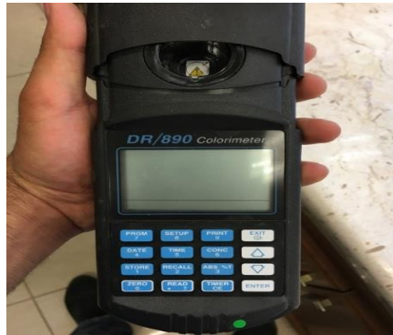
شكل رقم (7): يوضح جهاز DR 890 Colorimeter لفحص النترات.
